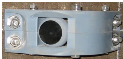
Figura 1a - Transdutores omnidirecional do tipo "Eyeball" Caldon Hydro TM - CAMERON. Fonte: acervo próprio
