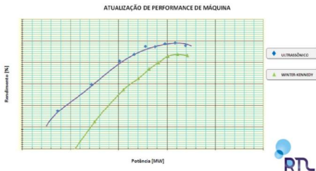
Figura 5 - Curvas de Potência x Rendimento medidas pelos métodos Winter-Kennedy e Ultrassônico [5]
