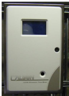
Figura 1b - Medidor de vazão ultrassônico modelo LEFM® 880 Series - Caldon Hydro TM - CAMERON. Fonte: acervo próprio
