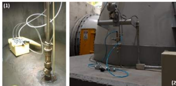
Figura 3 – Métodos por pressão diferencial – (1) Tubo de Pitot (2) Winter-Kennedy. Fonte: acervo próprio
